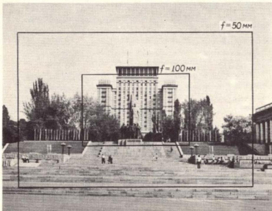
Фотообъектив МС КАЛЕЙНАР-5Н с многослойным просветлением линз предназначен для использования в качестве сменного с малоформатными зеркальными камерами КИЕВ-17 и КИЕВ-20. Он представляет собой длиннофокусную пятилинзовую оптическую систему и позволяет получать фотографии высокого качества при портретной съемке, съемке спортивных сюжетов, архитектурных ансамблей; при фотографировании растений, животных, птиц, а также при репортажных съемках с дальних расстояний.
