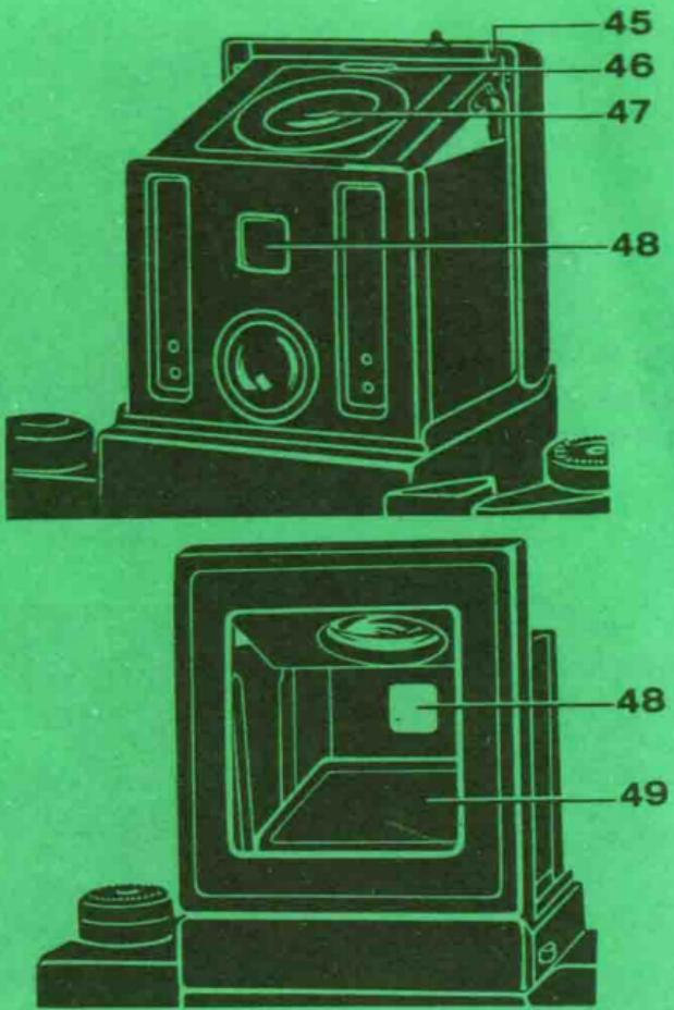
крышкой 49. При нажиме на крышку она поворачивается и фиксируется в крайнем положении.
