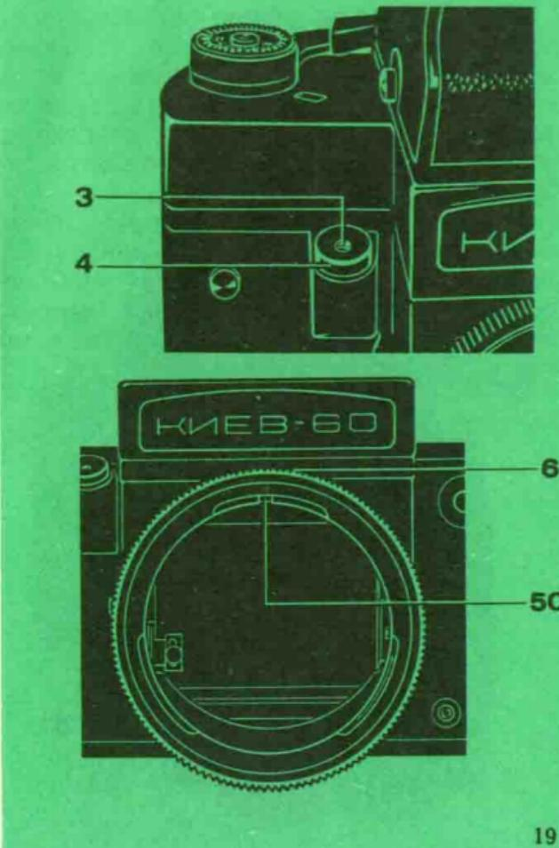
При установке объектива необходимо вставить его в камеру так, чтобы направляющий штифт 51 объектива попал в паз 50 на корпусе камеры. Затем поворотом гайки по часовой стрелке до упора плотно зажать объектив на корпусе.
